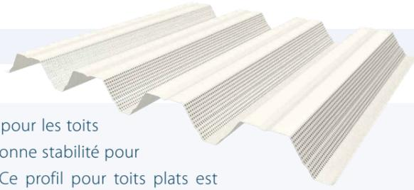
Le JI 85-280-1120 Perfo est un support profilé et perforé pour les toits plats. Cette tôle d'acier offre une grande portée et une bonne stabilité pour des applications dans le secteur industriel et tertiaire. Ce profil pour toits plats est disponible en plusieurs dimensions et finitions sur demande. En option, la face B peut être pourvue d'un revêtement intérieur.
