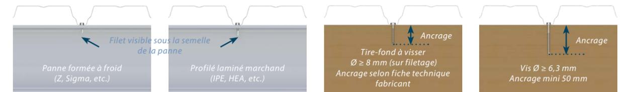
Vis à collerette incorporée ou avec rondelle,  $\text{Ø } 15 \text{ mm ép. } \geq 1,5 \text{ mm}$
