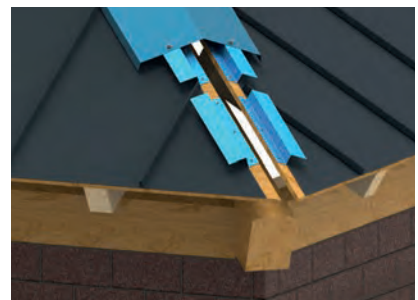
15/10 gegalvaniseerde Z-drager voor nok met standaardlengte van 400 mm.
