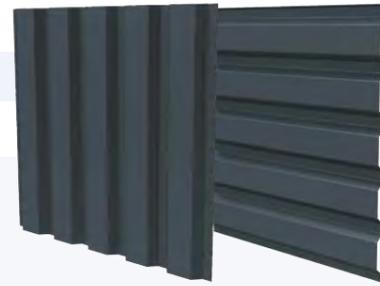
Trapezprofile sind im Querschnitt trapezförmig gerollte Profilbleche. Das Trapezblech JI 35-207-1035 dient der Wandverkleidung von außen mit Blech aus feuerverzinktem Stahl. Mit einem Trapezblech Sickenabstand von 207 mm und einer Höhe von 35 mm zeichnet sich das Modell besonders durch seine hohe Stabilität bei zugleich geringem Trapezblech Gewicht aus. Das Trapezblech ist in Deutschland gefertigt. Wir beraten Sie gerne zu Materialstärke und benötigter Tragfähigkeit der Trapez Bleche.
