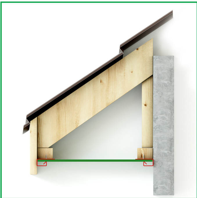
Fixare profil J pe sageac metalic perforat
