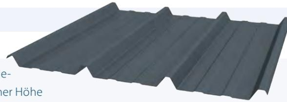
Das Trapezblech JI 45-333-1000 dient der Leichtdacheindeckung mit feuerverzinktem Stahl. Das Außenblech mit einer Höhe von 45 mm und einem Sickenabstand von 333,3 mm kann mit dem Isolierpaneel JID Roof PIR kombiniert werden. Das Trapezblech ist in vielen Längen und Materialstärken erhältlich. Wir beraten Sie gerne dazu, mit welcher Stärke Sie die von Ihnen benötigte Tragfähigkeit gewährleisten.
