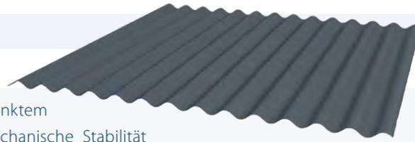
Das Sinus Wellblech JI 18-076-988 ist aus feuerverzinktem Stahl gefertigt. Es zeichnet sich durch eine hohe mechanische Stabilität bei zugleich geringem Gewicht aus. Mit einer Höhe von 18 mm und einem Wellenabstand von 76 mm eignen sich die Profilbleche hervorragend für Fassaden- und Dachverkleidungen. Das gewellte Blech ist in vielen Längen und Materialstärken verfügbar.
