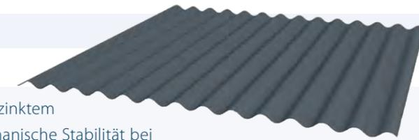
Das Sinus Wellblech JID 18-76-1064 ist aus feuerverzinktem Stahl gefertigt. Es zeichnet sich durch seine hohe mechanische Stabilität bei zugleich geringem Gewicht aus. Mit einer Höhe von 18 mm und einem Wellenabstand von 76 mm eignen sich die Profilbleche hervorragend für Fassaden- und Dachverkleidungen. Das gewellte Blech ist in vielen Längen und in einer Vielzahl von Materialstärken verfügbar.
