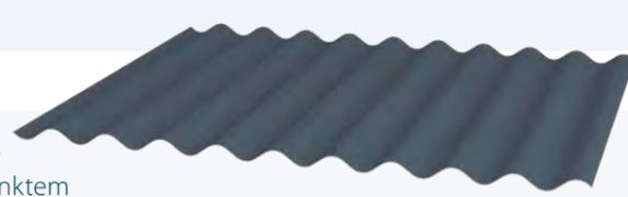
Wellbleche gehören zu den bekanntesten Profilblechen. Das Sinus-Wellblech JID 27-111-1000 ist aus feuerverzinktem Stahl gefertigt und zeichnet sich durch seine hohe mechanische Stabilität aus. Mit einer Höhe von 26 mm und einem Wellenabstand von 111 mm eignet sich das Wellblech hervorragend für Fassaden- und Dachverkleidungen. Das gewellte Blech ist in vielen Längen und in einer Vielzahl von Materialstärken verfügbar.
