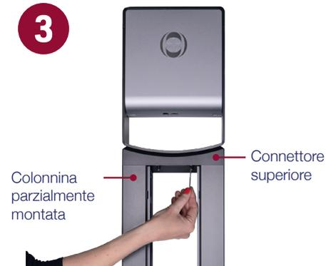
Fissare il dispenser alla colonnina parzialmente montata avvitando le 4 viti M3 x 25 alla base del dispenser con la chiave torx T10.
