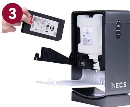
Inserire la batteria nella custodia con l'etichetta della batteria rivolta verso l'interno del dispenser. Quindi chiudere la levetta della batteria affinché il gancetto non scatta in posizione.
