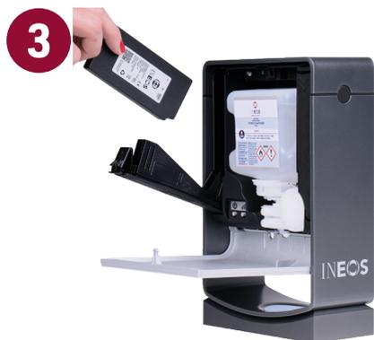
Insérez la batterie dans le logement, avec l'étiquette face à l'intérieur du distributeur. Fermez ensuite le compartiment à batterie jusqu'à enclenchement de la languette.
